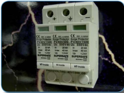
De PV43VT+V-600-CD-S is een steekbare type 2, klasse C overspanningsbeveiliging, welke dient ter bescherming van fotovoltaïsche installaties tegen over- en inductiespanningen. De dinrailbeveiliging dient parallel op het DC netwerk aangesloten te worden. Geadviseerd wordt de overspanningsbeveiliging aan zonnepaneel en aan inverter zijde van het DC systeem aan te brengen, zeer zeker wanneer er grote/ externe afstanden afgelegd worden.
