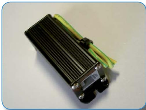
De ST-170-01 RJ11 is een overspanningsbeveiliging (OVP) voor de beveiliging van één analoge telefoon/adsl lijn voor telefoon-, fax-, data- en modemapparatuur ter bescherming van de A- en de B- ader. De unieke combinatie van langs- en dwarsspanning garandeert u een optimale communicatieverbinding. Geschikt voor wandmontage. Eenvoudig te installeren. Voorzien van RJ 11 connectoren.
