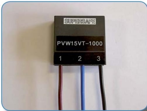
De PVW15-VT-1000 is een type 2, klasse C overspanningsmodule voor fotovoltaïsche (PV) installaties, voorzien van aansluitdraden. Speciaal ontwikkeld ter voorkoming van over- en inductiespanningen in PV-systemen. De PVW15-VT-1000 dient parallel geïnstalleerd te worden aan de installatie. Geadviseerd wordt de overspanningsbeveiliging aan zonnepaneel zijde en aan inverter zijde van het DC systeem aan te brengen, zeer zeker wanneer er grote, externe afstanden worden afgelegd.
